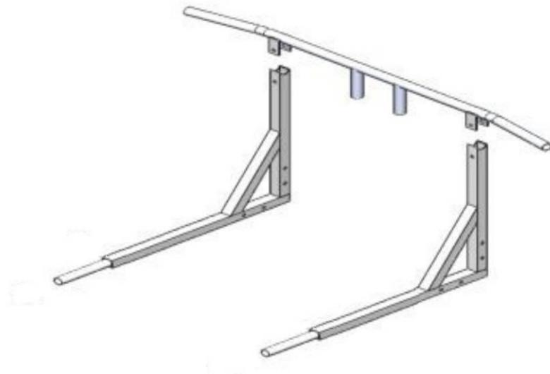
3.6. Установите две перекладины (поз. 3) используя болты (поз.7), в соответствии с рисунком ниже, затяните все гайки:
